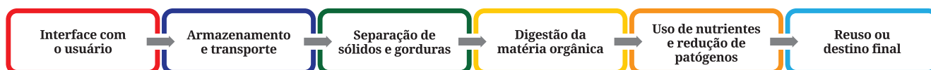
Figura 2. Etapas envolvidas na gestão de efluentes domésticos conforme definidas no CataloSan (FUNASA, 2018).
